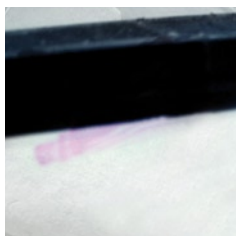
Test naprężenia powierzchniowego
