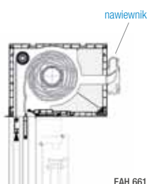
nawiewnik EAH montowany w kasie rolety zewnętrznej
